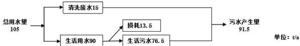
图 2.4-1 本项目水平衡图
