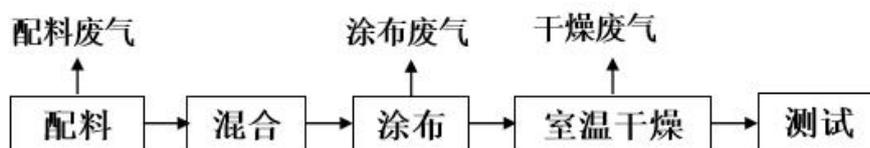
图 2.3-2 涂布试验流程图
